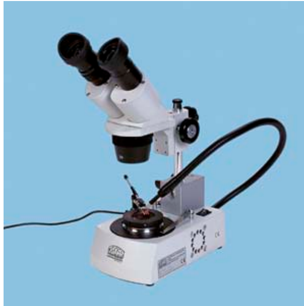
Mikroskop 10x / 30x Reflektiertes - transmittiertes Licht - Steinhalter - Dunkelfeld - Kaltlicht vertikaler Aufbau
