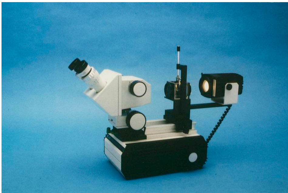
Mikroskop 10x / 30x Reflektiertes - transmittiertes Licht - Steinhalter - Dunkelfeld - Kaltlicht vertikaler Aufbau
