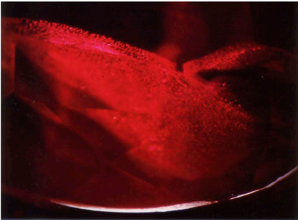
Synthetischer Rubin nach Chatham mit gefestigten Flussmittelrückständen und verdrehten Fahnen (Flussmittelfahnen); Durchlicht – 10 fach.
