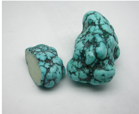
Gebeizter Magnesit auf Turquoise. Querschnitt zeigt die farblose Struktur;
