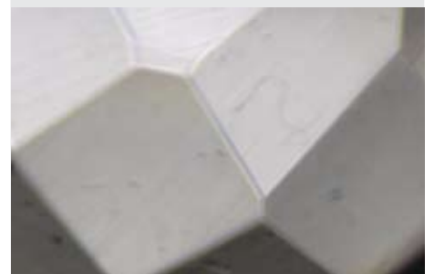
Deutlich erkennbare Schliiffkantendoppelbrechung, 15x, Tansania
