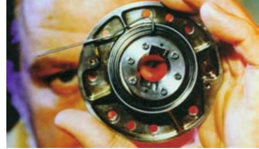
Für die zur Venus gesandte Sonde im Jahr 1978 wurde das infrarotdurchlässige Diamantfenster mit 18,2 mm Durchmesser, 2,8 mm dick, noch aus einem natürlichen Diamant geschliffen.
