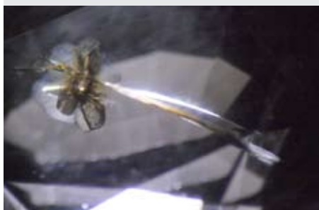
Fremdkristall mit "blumenartigen Flüssigkeitshöfen" und einem darüberliegenden Spaltriss, 15x, Tansania
