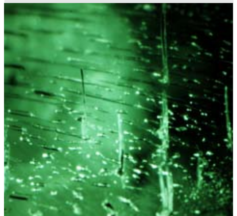
Abb.4: Gefestigte Flussmittelrückstände in „spitz zulaufender“ Form, 25x.
