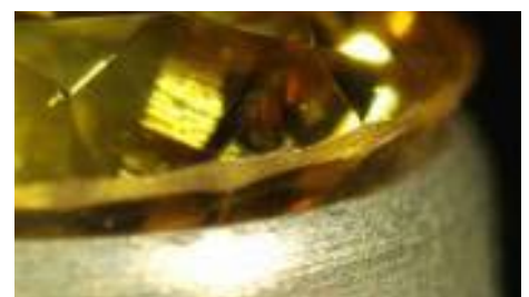
Abb.35: Geriebene Rondiste an einem synthetischen Brillanten nach „TAIRUS“ in Fancy-Color. Synthetische Brillanten besitzen keine ÄTZFIGUREN
