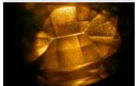
Abb.5: Flächenförmig und, griesartig aussehender Schmelzrückstand; 25x
