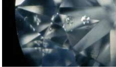
Abb.41: Brillant mit einem inneren Merkmal (Einschluss) und mit Totalreflexion.
