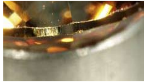
Abb.7: Alle Rondisten sind überwiegend beschädigt, d. h sie zeigen „Granierungen“, die es bei Diamant/ Brillant in dieser Erscheinung niemals gibt.
