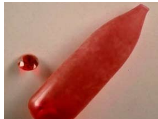
Abb. 3: Schmelzbirne (Boule) für synthetischen Rubin nach Verneuil.
