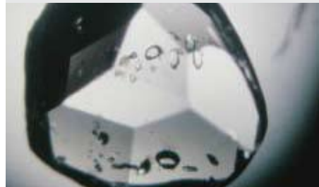
Abb.42: Diamant mit inneren Merkmalen (Kristalleinschlüsse).
